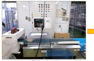
ラーメンは、金属類の混入が無いか、既定の 重量かを確認する機械を通り、その後、人の 手で1袋ずつ目視で確認を行います。
