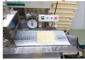
薄くした生地は『切り刃』でラーメンの細さと 長さにカットします。カットした後は自動で 袋詰めをする機械のところまで運ばれて いきます。
